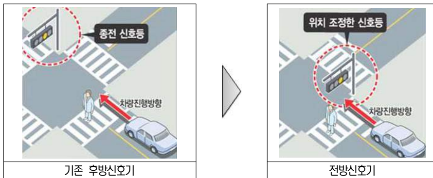
기존 후방신호기 및 전방신호기 설치 예시도
